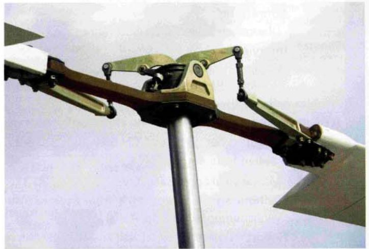
Gelenklose Rotorköpfe mit Elastomer-Strang. Die Blattwinkelverstellung erfolgt über zwei Hebelarme.
