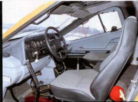
Автомобильный руль — бутафория. Управление машиной осуществляется с помощью двух рычагов слева и справа от водителя
